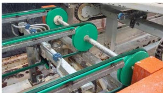
Le cinghie a cresta BEHAbelt sono realizzate in materiale PU o TPE termosaldabile. Sono particolarmente adatte a percorsi di trasporto difficoltosi nell'industria dei materiali edili e delle piastrelle. Questa gamma di prodotti include materiali estremamente resistenti all'usura in diverse durezze Shore.
