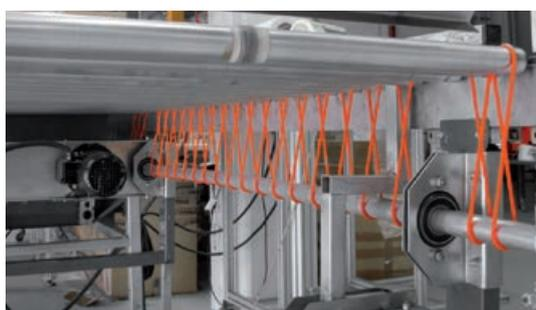
Le cinghie a gancio – od anche cinghie tonde ritorte – sono adatte a sistemi di trasmissione o trasporto nei quali più cinghie vengono montate su un unico albero. Sono rapidamente sostituibili con un facile montaggio. Le lunghezze disponibili vanno da 250 a 710 mm.
