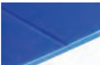
Stoßverschweißung mittels Schweißspiegel
