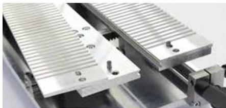
Im Falle der Verwendung von optionalen Adapterplatten sind diese in die vorgesehenen Arretierungsstifte auf dem Fügetisch einzulegen.
