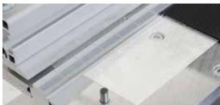
Wir empfehlen zusätzlich die Auflageflächen des Fügetischs kantenbündig mit doppelseitigem Klebeband zu versehen, um das Einlegen der Bandenden zu vereinfachen, aber auch ein mögliches Verrutschen der Bandenden während des Schweißprozesses zu verhindern.
