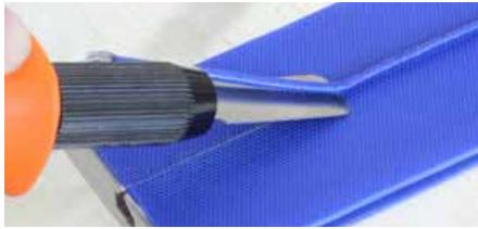
Den überstehenden Wulst mit dem Wulstentferner EM01 entgraten. Dabei ist die schräg angeschliffene Klinge des Wulstentfeners entsprechen in diesem Winkel auf die Bandoberfläche aufzusetzen und gleichmäßig über den Nahtbereich zu bewegen.
