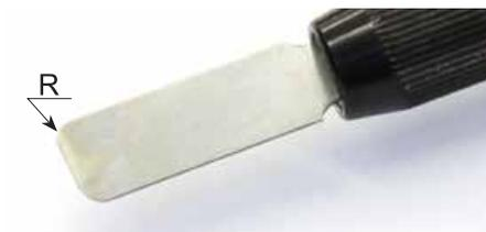
Wir empfehlen dringend bei neuen Klingen vor dem Einsatz die Ecken der Schnittfläche mit einem Radius zu beschleifen, um ein Einhaken oder eine Beschädigung der Bandoberfläche beim Entgratvorgang zu verhindern.
