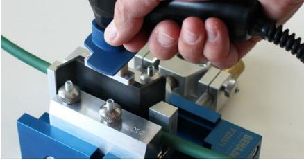
Den Schweißspiegel in den Spalt zwischen den Riemenenden einführen.
