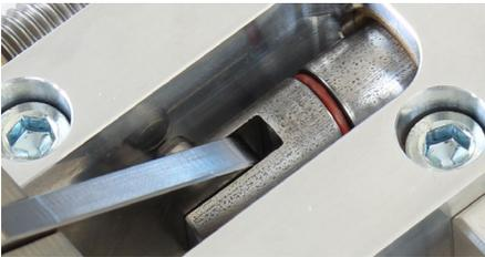
Kniehebel nach vorne schieben und Riemenmaterial aufschmelzen bis Widerstand zu stark oder rote Markierung knapp unter Metallabdeckung verschwindet.
