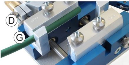
Einseitiges Einklemmen des Riemenprofils in die Nut des Klemmstückes.
