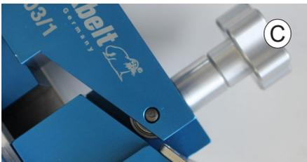
Kniehebel komplett öffnen. Anschlagplättchen für axialen Anpressdruck ausklappen. Mit Einstellrad (C) Kugellager so einstellen, dass dieses bei geschlossenem Kniehebel mit Anschlagsschräge leicht in Berührung kommt. Überprüfung der Position durch Öffnen und Schließen des Kniehebels.
