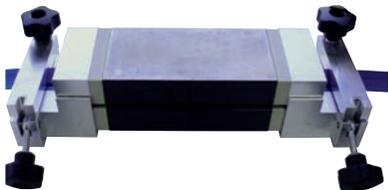
Para cerrar, coloque la parte superior de forma precisa sobre la parte inferior entre los puentes guía. En la soldadura solapada, al principio la parte superior y la parte inferior no se tocan, ya que el material aún debe desplazarse durante el proceso de soldadura o durante el tiempo de permanencia.
