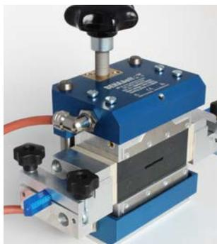
Installer l'empreinte avec le profil dans la presse à chaud : L'installer au centre dans le sens de la longueur. Les rainures dans l'empreinte et celles dans les parties supérieure et inférieure du boîtier doivent se chevaucher. Installer l'empreinte de manière centrée par rapport aux plaques chauffantes dans la longueur.
