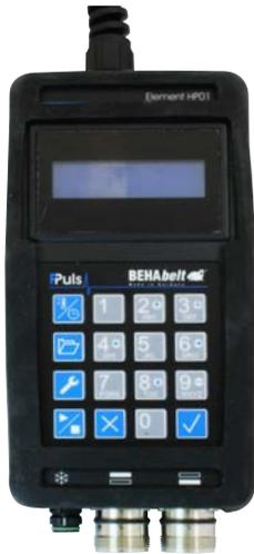
Den Netzstecker des PPuls Controllers am Netz anstecken und den PPuls Controller einschalten. Wahl der Schweißparameter durch Direkteingabe oder Auswahl gespeicherter Rezepte.
