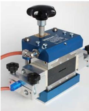
Den Formschuh mit Profil in die Heißpresse längs mittig vermittelt einsetzen:
