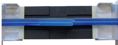
Installer les deux extrémités au centre et les fixer sur le côté avec les vis de serrage. Les extrémités coupées des courroies doivent se chevaucher et être alignées l'une sur l'autre. Les rainures fraisées de l'empreinte sont orientées vers le centre des parties supérieure et inférieure.
