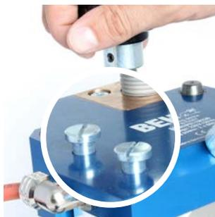
Gire el tornillo de mando estrellado hacia la derecha para desplazar hacia abajo la placa calentadora superior hasta que entre en contacto con el molde. A continuación, siga girando el tornillo de mando estrellado hasta que las cabezas de los tornillos se levanten 3-4 mm de la placa superior de la carcasa.
