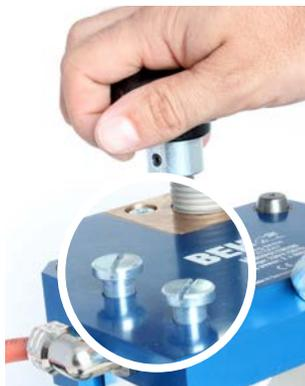
Déplacer la plaque chauffante supérieure vers le bas en tournant la vis à molette vers la droite jusqu'à ce qu'elle soit en contact avec l'empreinte. Puis continuer à tourner la vis à molette jusqu'à soulèvement des têtes de vis de 3 à 4 mm de la plaque supérieure du boîtier.
