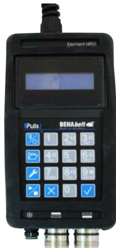
Conecte el enchufe de red del controlador PPuls a la red y conecte el controlador PPuls. Realice la selección de los parámetros de soldadura mediante introducción directa o selección de las fórmulas guardadas.
