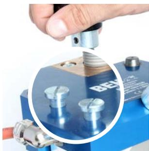
Déplacer la plaque chauffante supérieure vers le bas en tournant la vis à molette vers la droite jusqu'à ce qu'elle soit en contact avec l'empreinte. Puis continuer à tourner la vis à molette jusqu'à soulèvement des têtes de vis de 3 à 4 mm de la plaque supérieure du boîtier.
