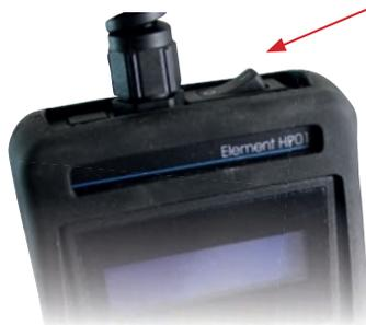
Actionner l'interrupteur Arrêt sur le contrôleur PPuls ou débrancher la fiche de la prise secteur.
