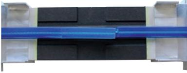
Die beiden Enden mittig einlegen und seitlich mit den Klemmschrauben befestigen. Die beschneittenen Riemenenden liegen dabei bündig überlap-pend übereinander. Die eingefrästeten Nuten des Formschuhs zeigen die Mitte des Ober- und Un-terteils.
