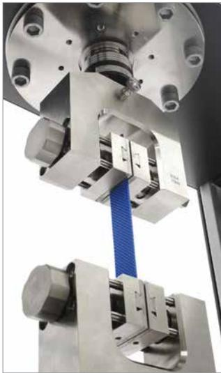
Angelehnt an die Norm ISO 21181 definiert der k1%-Wert (N/mm) das Elastizitätsmodul für Transportbänder. Er zeigt an, wie viel Kraft in Newton pro mm Bandbreite erforderlich ist, um ein Band um 1% zu dehnen.
