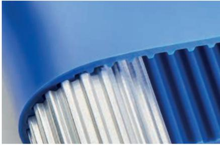
Die formschlüssigen AT5-Transportbänder ermöglichen einen schlupffreien Transport und das schon bei kleinsten Scheibendurchmessern von nur Ø 18 mm. Somit sind nun auch Förderabschnitte mit kleinsten Übergabebedingungen mit einer schlupffreien Bandlösung zu realisieren. Durch die sorgfältige Auswahl der Rohstoffe für den direkten Lebensmittelkontakt bieten die Bandlösungen eine sehr gute Mikroben-, Hydrolyse- und Chemikalienbeständigkeit.
