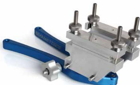
Passende Führungszange für das Verschweißen von bis zu 80 mm breiten Flachbandstreifen
