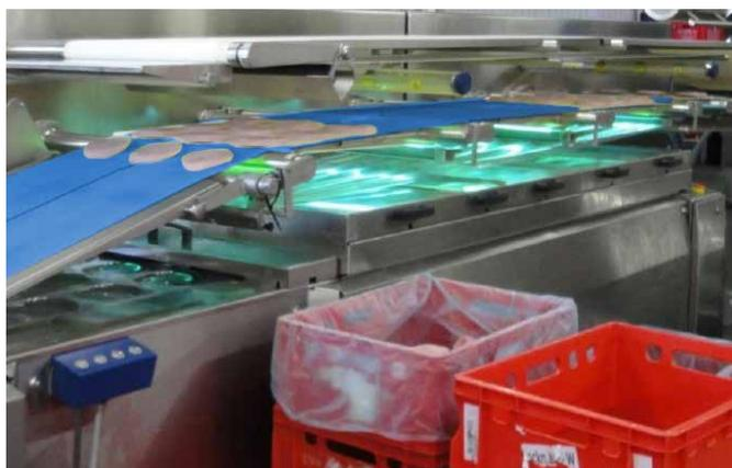
Unterstützend zur regelmäßigen Reinigung werden mehr und mehr Förderanlagen mit UV-C-Strahlern ausgestattet. Dies dient zur besseren Kontrolle der Keimzahlen auf Lebensmittelkontaktflächen auch während des Produktionsprozesses. Diese Art von Bestrahlung führt bei fehlendem Schutz zur Versprödung und Verfärbung der Bandoberfläche. Mit der Beimischung eines UV-C-Schutzes in unsere Rohmaterialien garantieren wir eine höhere Lebensdauer und Sicherheit unter solchen Anwendungsbedingungen.
