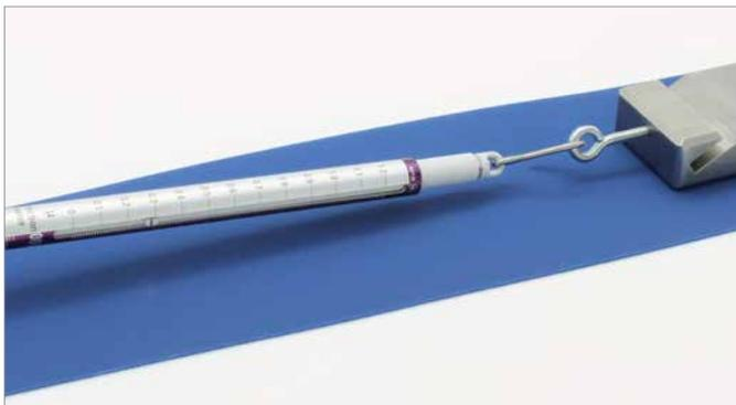
Der Effekt des kurzzeitig wirkenden höheren Haftreibwerts beim Anfahren (beträgt ca. das 1,3- bis 1,8-fache des dynamischen Reibwerts) wird üblicherweise über den gewählten Sicherheitsfaktor des Konstrukteurs in der Anlagenauslegung berücksichtigt.
