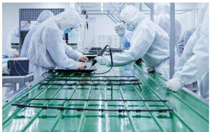
Für besonders sensible Prozessabschnitte mit elektronischen Mess- und Steuereinheiten wie z.B. check weigher (online Wiegeprozesse) oder Förderabschnitten mit elektronischen Bauteilen werden Bänder mit antistatisch ableitender Eigenschaft benötigt, um Störungen bzw. Messfehler zu vermeiden.
