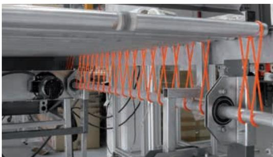
Hakenriemen – oder auch gedrehte Rundriemen – sind für Antriebs- oder Transportkonstruktionen geeignet, bei denen mehrere Riemen auf einer Welle sitzen. Sie können durch einfache Montage schnell ausgetauscht werden. Verfügbare Längen sind von 250 bis 710 mm.
